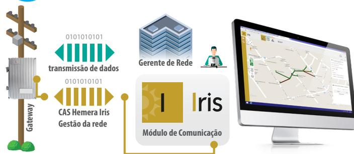
Tecnologia de comunicação robusta com modelos de conectividade para adequação às demandas de negócio. Possui capacidade de comunicação com medidores de água, gás e energia e sensores de forma integrada à plataforma de gestão dos dados de medição. Disponibiliza também recursos avançados para gerenciamento contínuo da comunicação a favor da disponibilidade de dados e múltiplas comunicações simultâneas. Possui integração com sistemas supervisórios (SCADA).
